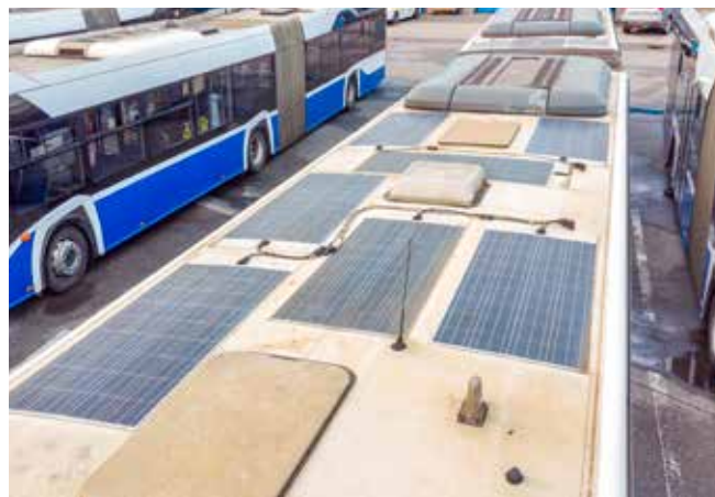
Panele fotowoltaiczne na dachu autobusu
