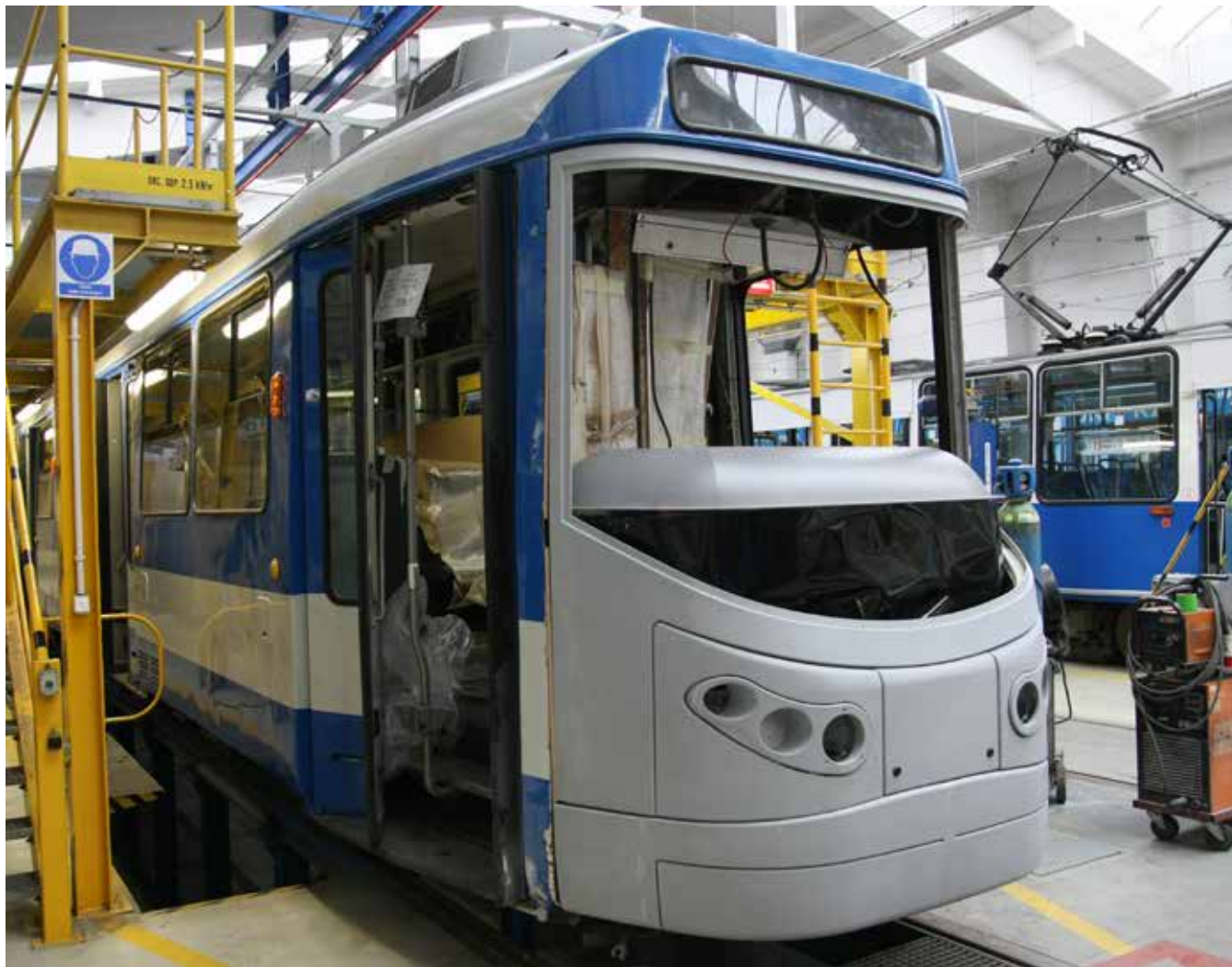
„Przymiarki” ściany czołowej wagonu GT85 numer 3060 w Stacji Obsługi Tramwajów Podgórze, przed wprowadzeniem tramwaju do ruchu. Fot. Tomasz Bielecki
