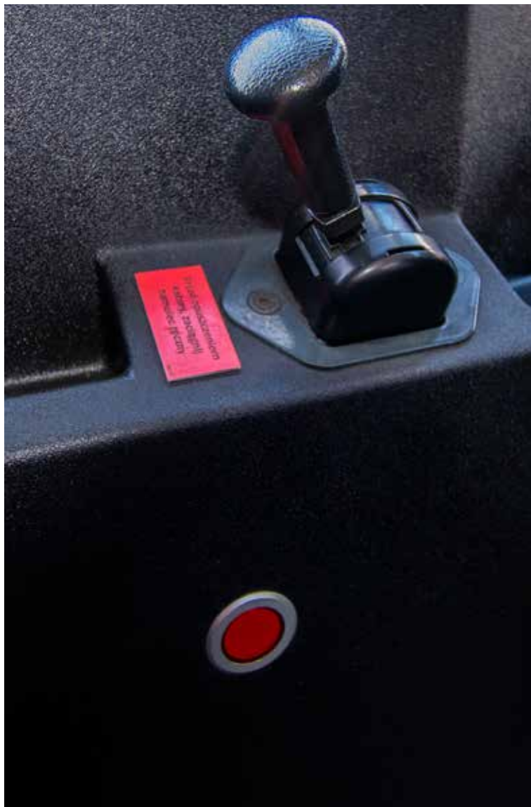
Przycisk ma za zadanie błyskawicznie przekazać informację o zagrożeniu do Głównej Dyspozytorni Ruchu MPK
