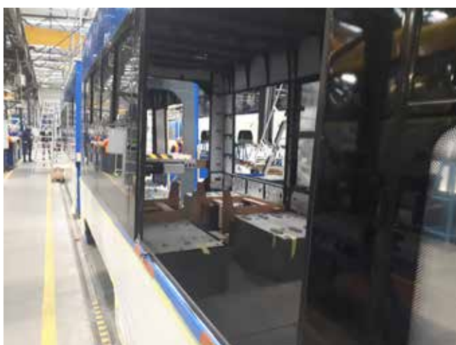
Montaż szyb w tramwaju
