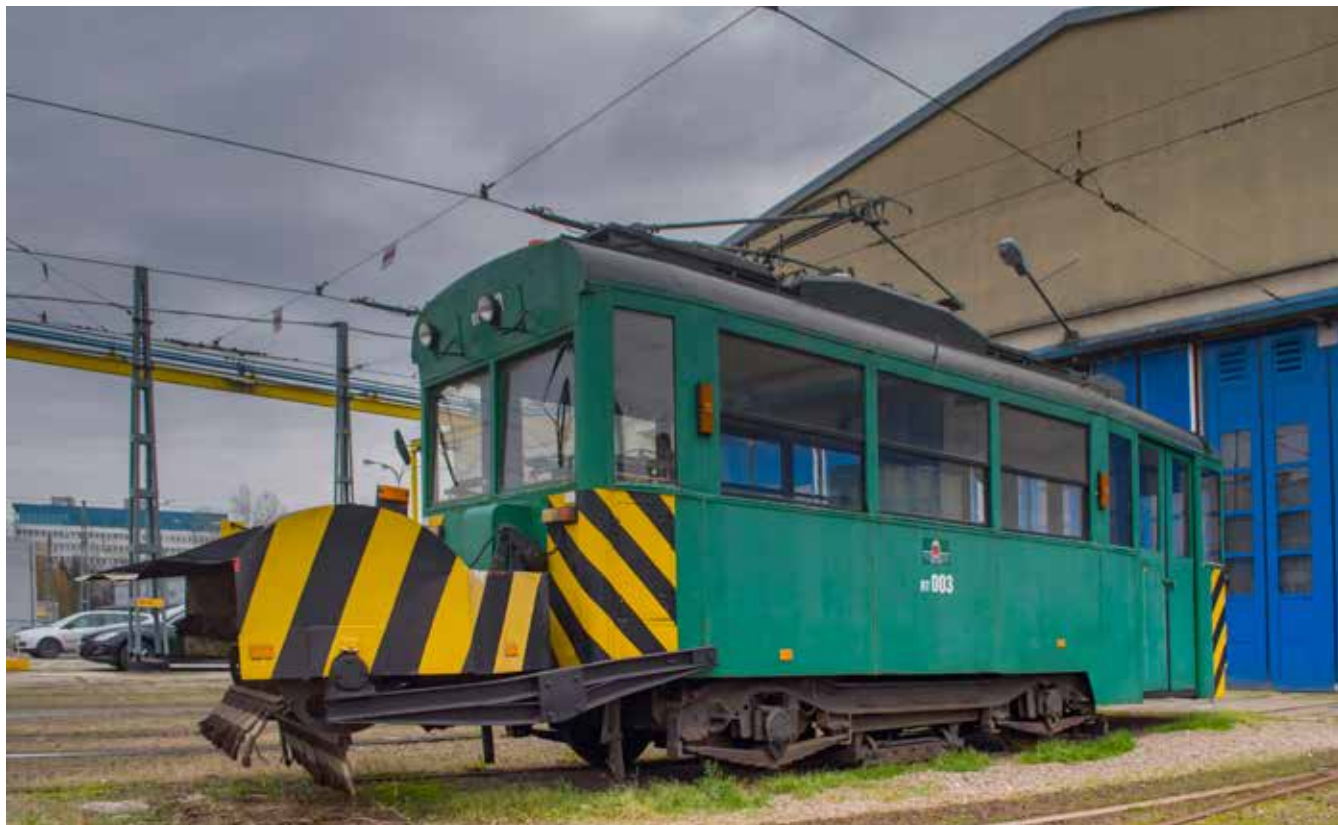
Oprócz tramwaju do zabezpieczania sieci przed oblodzeniem, MPK S.A. posiada także tramwajowy pług do odśnieżania torowisk
