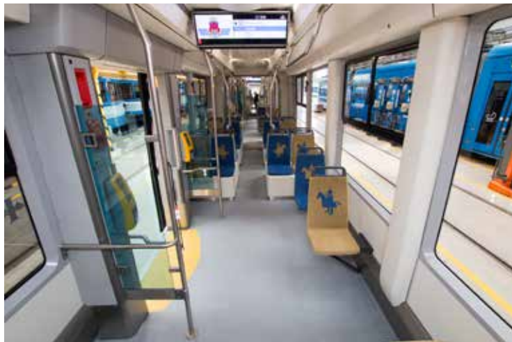
Nowe tramwaje będą posiadać 85 proc. niskiej podłogi
