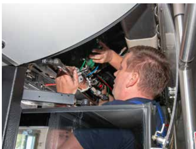
Mechanicy musieli odpowiednio wyregulować zamykanie drzwi
