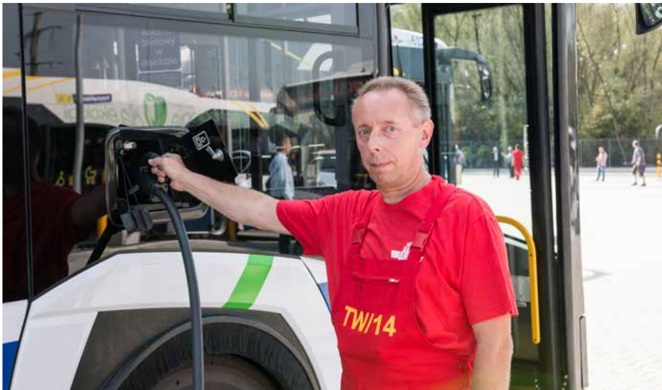
Ładowanie autobusu przez wtyczkę (plug-in)
