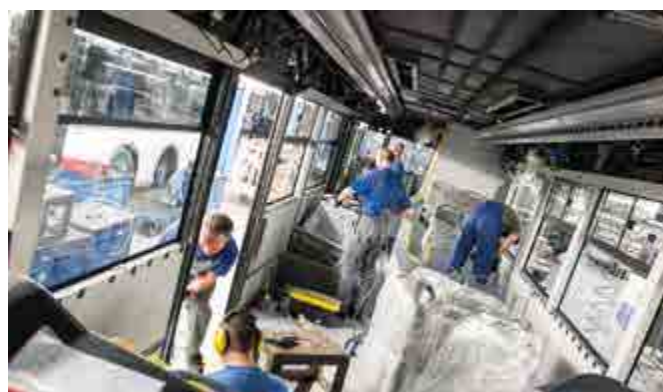
Montaż siedzeń, drzwi oraz reszty elementów w środku pojazdu
