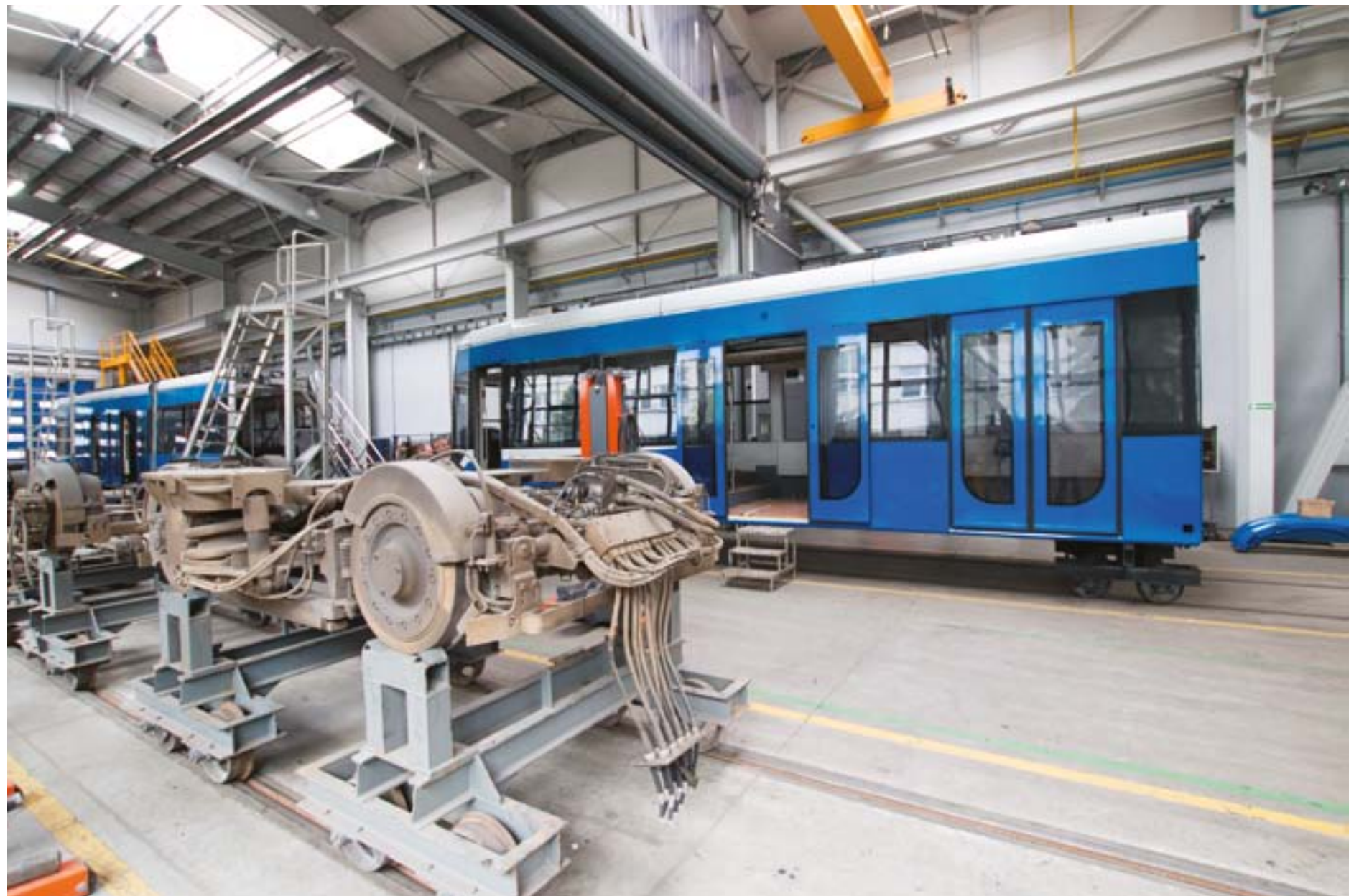
Ważnym elementem tramwaju, który jest systematycznie przeglądany jest wózek
