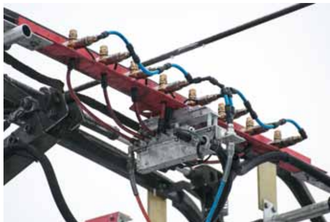
Dysze natryskowe odpowiadają za rozprowadzanie substancji na sieci
